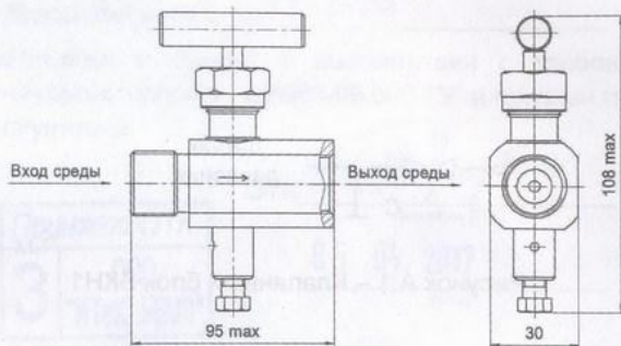
Рисунок Б.1 – Клапанный блок БКН1
